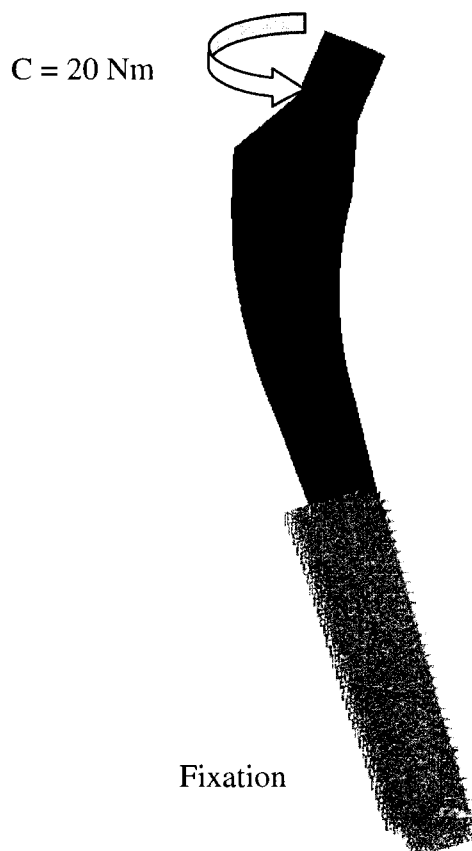
Figure 5-15 : Représentation schématique de l'essai de torsion sur la prothèse fixée à angle de 16,5°
