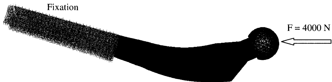
Figure 5-6 : Représentation schématique de l'essai de compression sur la prothèse fixée à 16,5^\circ d'inclinaison
