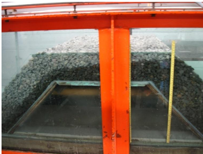
Figure 4-8: Présentation de la nappe d'eau à travers la digue en enrochement
