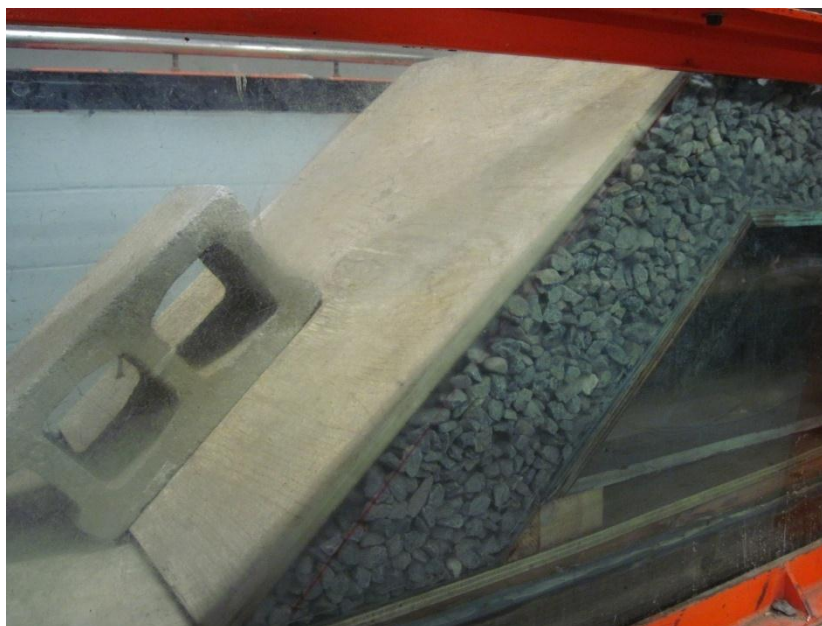
Figure 4-3: Planche en bois retenant l'enrochement lors de son emplacement
