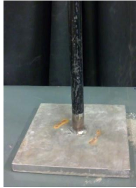
Figure 4-2: Marteau mécanique de compactage
