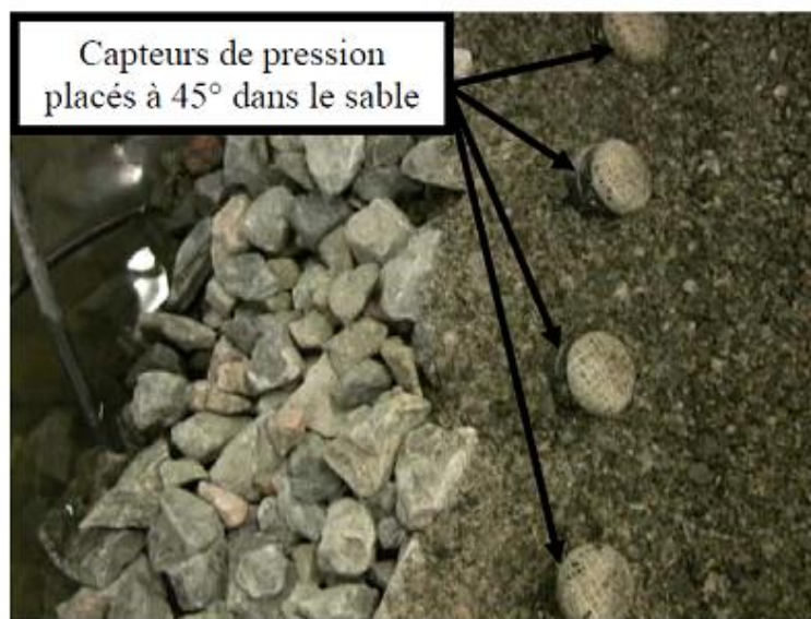
Figure 3-18: Montage utilisé pour la calibration des capteurs submersibles placés dans la couche de sable
