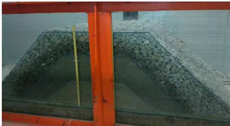
Figure 4-1: Marque des dimensions des couches sur les vitres des parois latérales du canal
