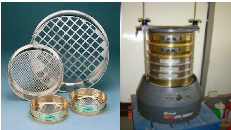
Figure 3-9: Série de tamis et agitateur utilisés pour l'analyse granulométrique
