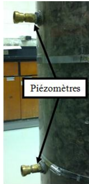
Figure 3-15: Piézomètres installés sur la paroi du perméamètre
