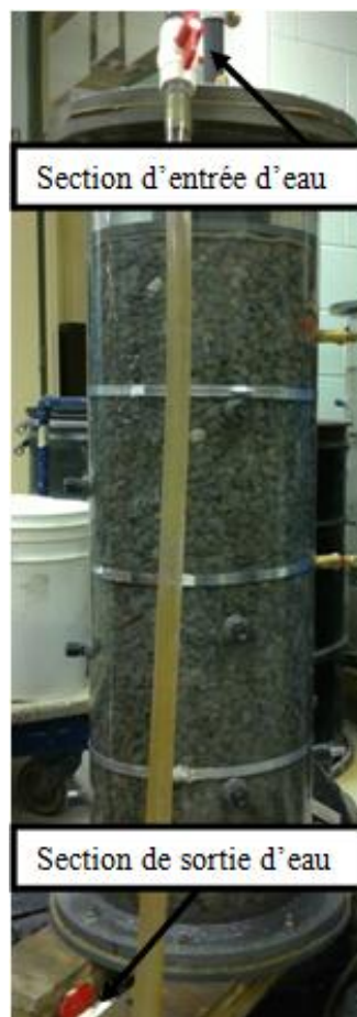
Figure 3-14: Perméamètre utilisé lors de l'étude d'écoulement unidirectionnel à travers l'enrochement
