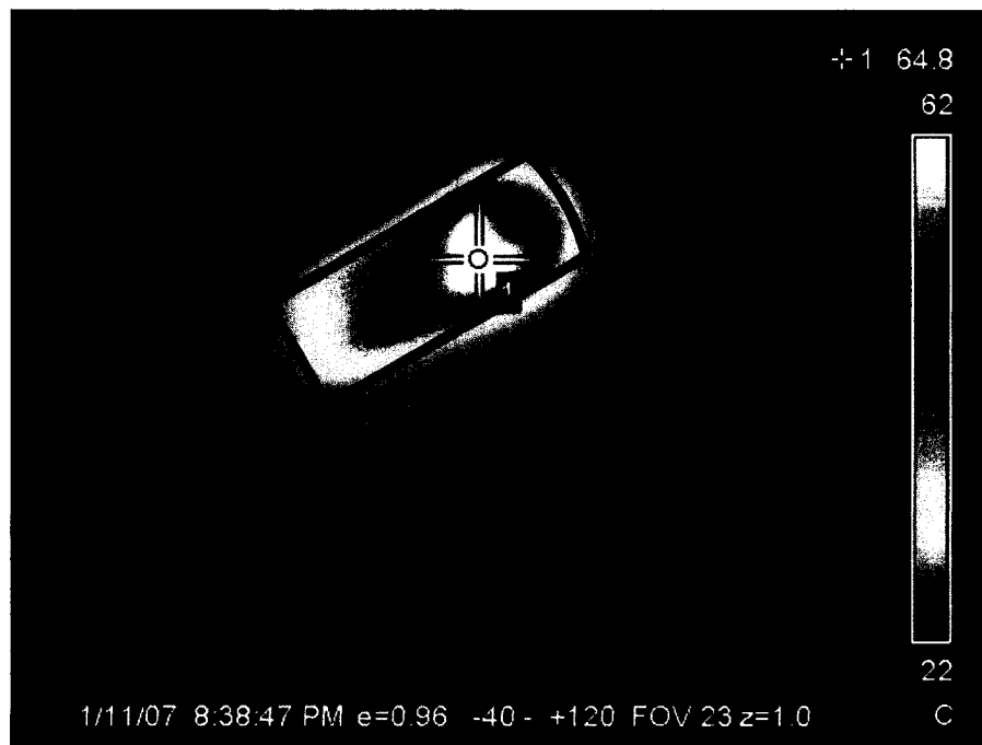
Figure 3.11 : Photographie du profil thermique du bilame pour une tension d'activation de 2 V.
