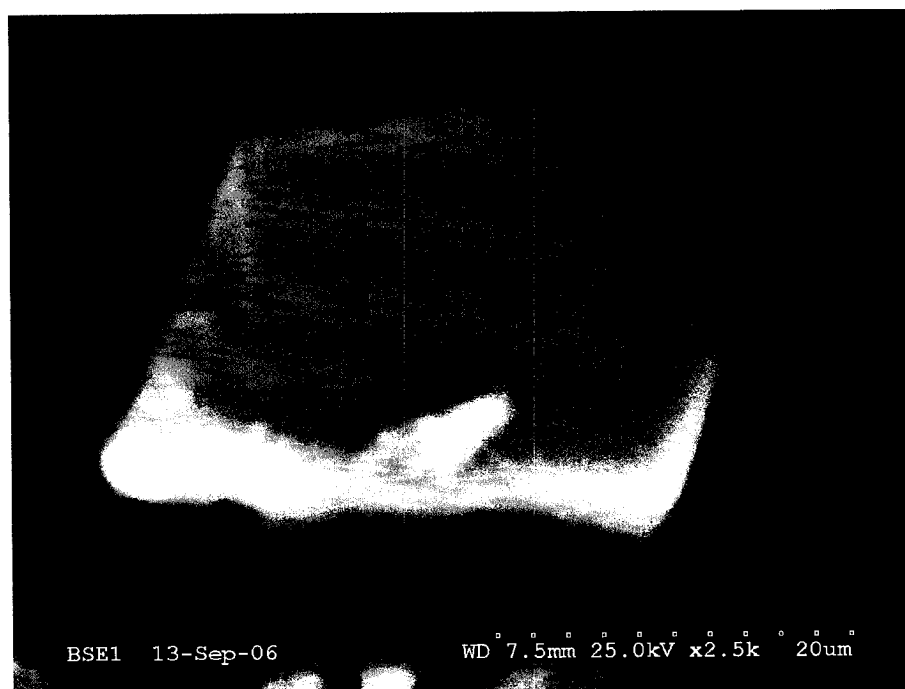
Figure 4.10 : Image MEB en mode électrons rétrodiffusés montrant un grain de portlandite bien cristallisé de l'échantillon QG0_90 (x2500)
