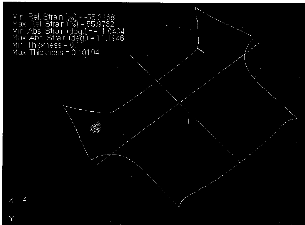
Figure 2-20 : Exemple de drapage par minimisation de l'énergie de cisaillement du moule PF3.
