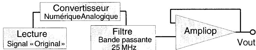
**Figure 3-7 Schéma bloc de la reconstruction du signal «Original » analogique.**
