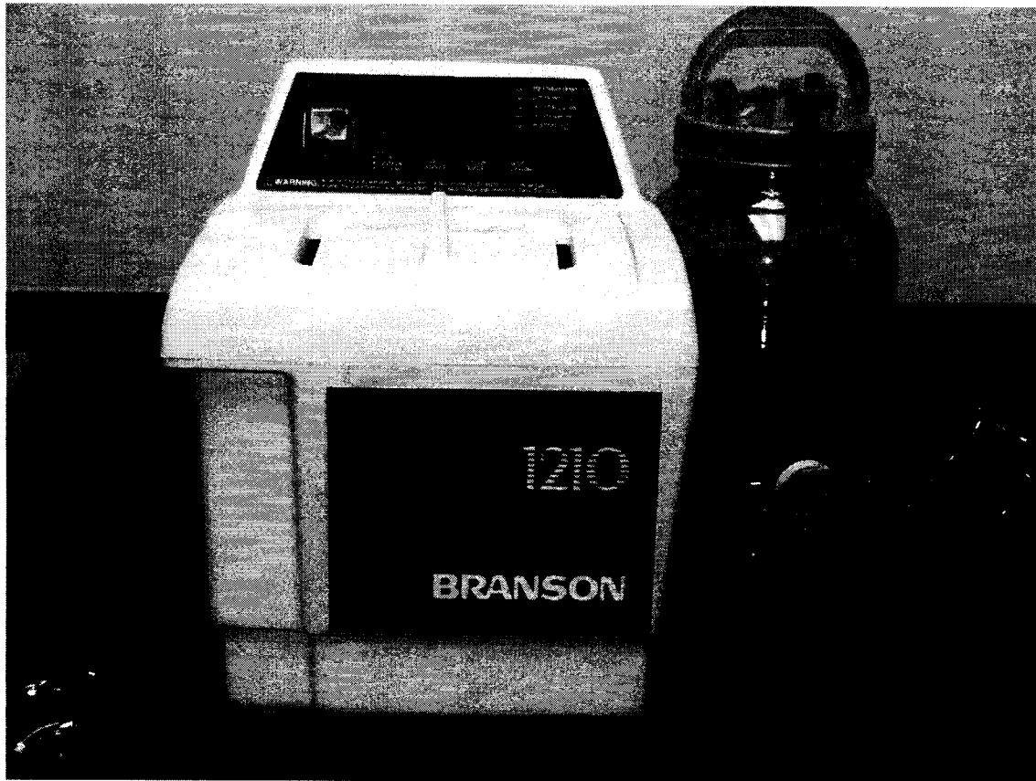
**Figure 4-16 Appareil de nettoyage par ultrasons**
