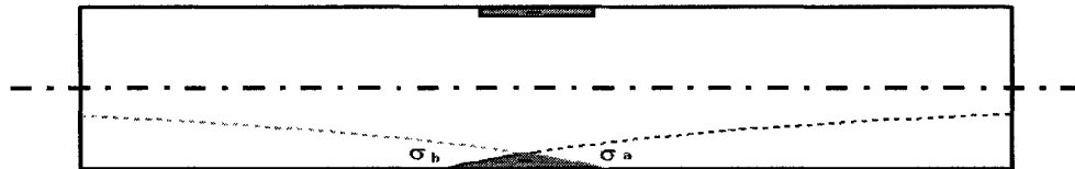
Figure V Contraintes résiduelles générées après le redressage par grenaillage
