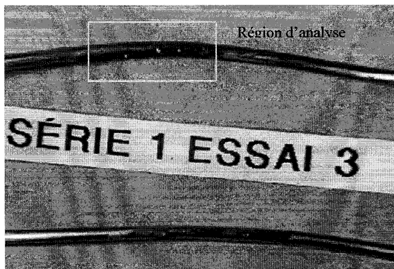
Figure 5.76 : Région d'analyse de composition sur conducteur de cuivre portant un endommagement par court-circuit
