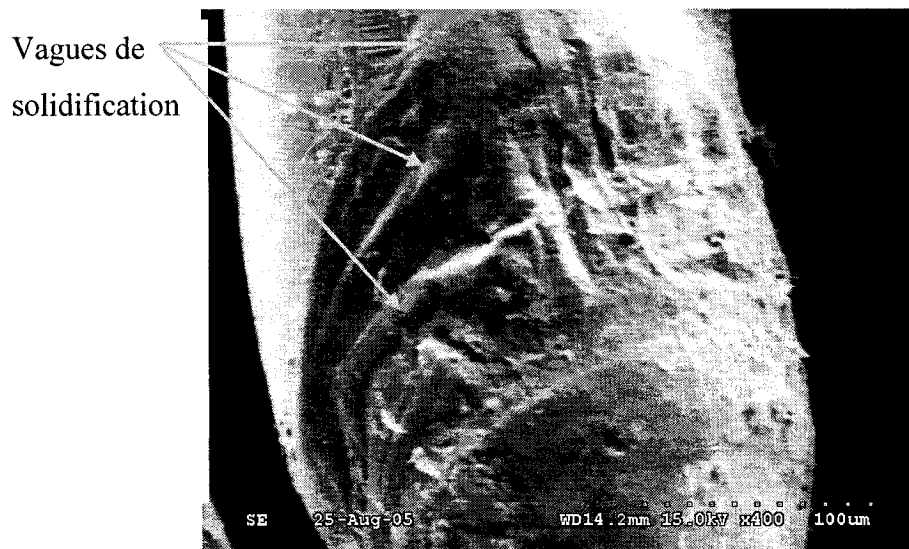
Figure 5.86 : Vagues de solidification produites en surface d'une zone affectée par court-circuit sur un conducteur de cuivre multibrins endommagé en laboratoire
