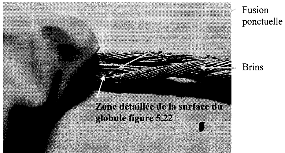
Figure 5.21 : Dommage ponctuel par fusion thermique sur un seul conducteur multibrins de cuivre endommagé thermiquement en laboratoire (2004)
