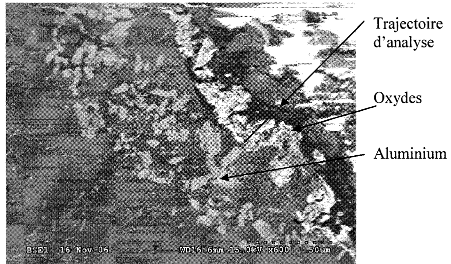
Figure 5.33 : Fusion thermique de l'aluminium en périphérie de l'interface zone fusionnée et matériel d'enrobage avec trajectoire d'analyse
