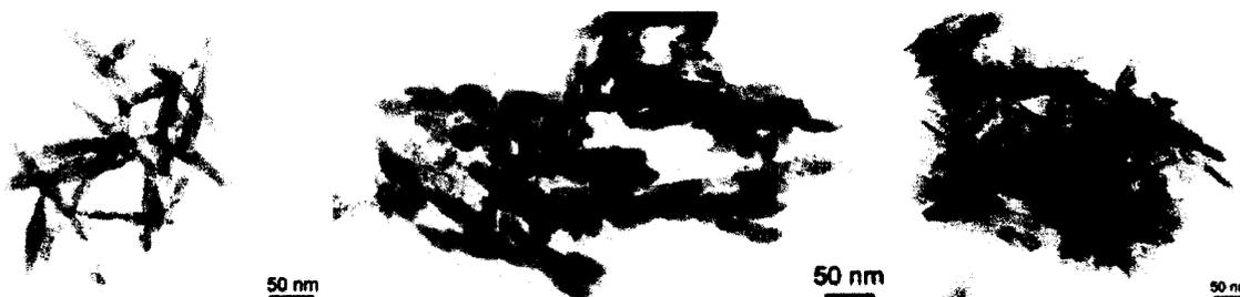
**Figure 2.7 :** Nanocristaux d'HA synthétisés à différentes températures de réaction (a) 35°C; (b) 85°C. (c) synthétisés avec le  $V_{add} = 2400$  ml/min (Bouyer et al. 2000)
