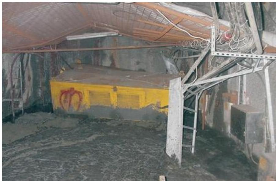
Figure 2.28 : Matériel endommagé par la rupture d'une barricade à la mine Cayeli (d'après Yumlu et Guresci, 2007)
