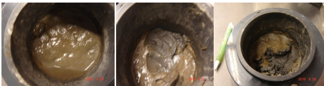
Figure 4.16 : Photo des échantillons presque saturés en eau après une douzaine de jours d'essai CO dans une cellule à un seul réservoir.
