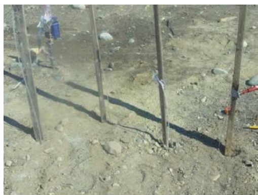
Figure 3.14: Configuration typique pour l'échantillonnage du gaz interstitiel avec des pointes dédiées implantées à différentes profondeurs de la CEBC du site LTA.
