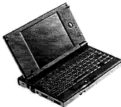
Figure 1.34 - Boîtier d'un ordinateur portable fabriqué en magnésium par thixomoulage®, [54].
