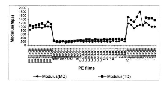
FIG 6.4. Measured tensile modulus
