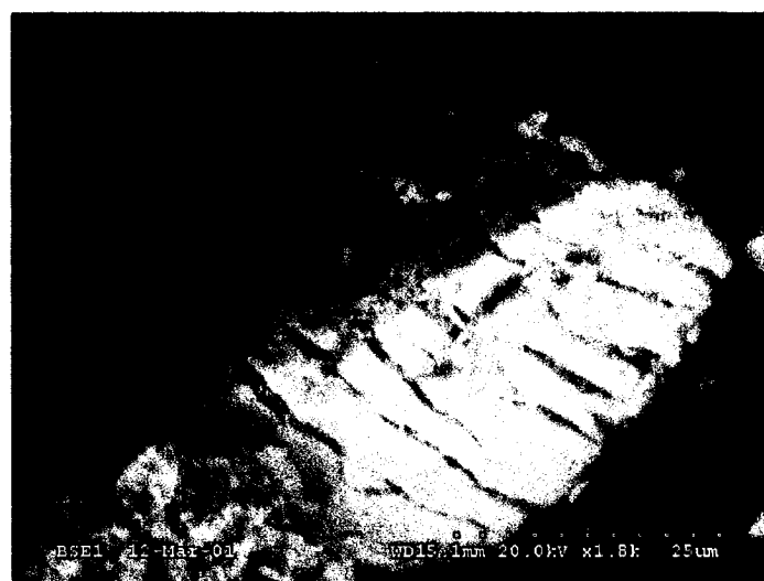
Figure 3.4 : Grain de sulfure de fer craquelé présentant des signes d'oxydation dans les fissures. Échantillon Solbec-Manitou
