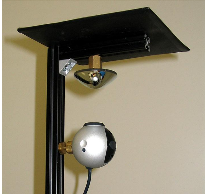
FIG. 2.4 Caméra omnidirectionnelle montée sur les plates-formes mobiles
