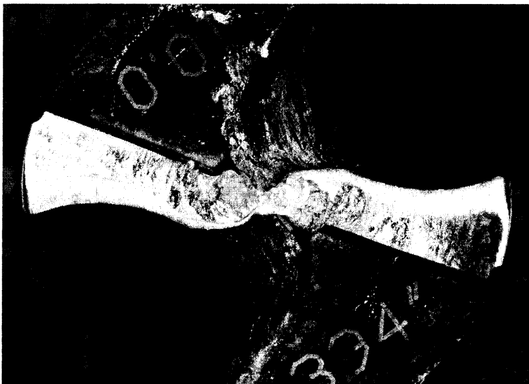
Fig. 3.101. Matériau collé de façon permanent sur la plaquette.
