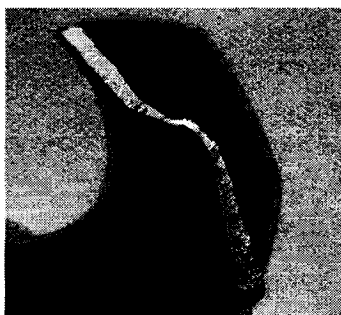
Annexe 3-2 , Figure 4: Détail usure du coin. Foret en acier rapide, avance 0.1 mm/rev constante, rpm variable.
