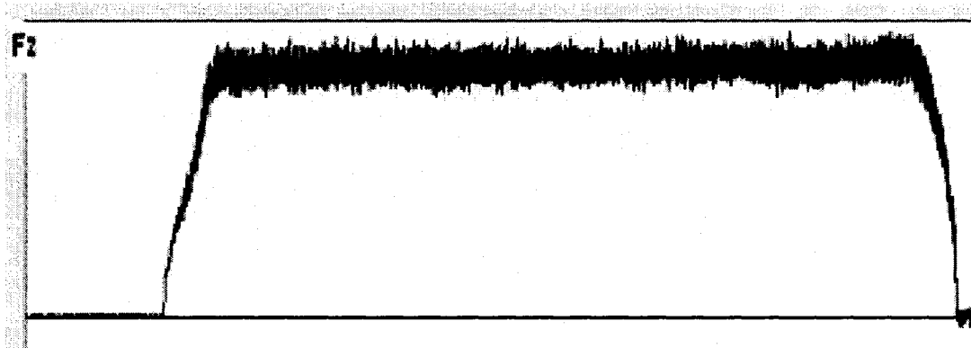
Figure: 3.71. Allure globale de la force F_z pour forets en carbure solide.
