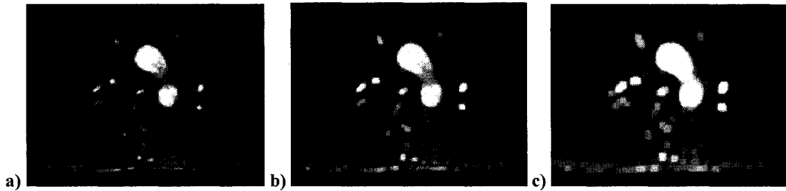
Figure 2.7 : Application du filtre de dilatation fonctionnelle. Données initiales en a) et données résultantes après une application du filtre en b) et deux applications du filtre en c).
