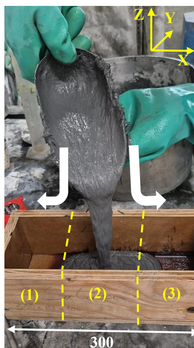
Figure 3.29 : Coulée avec orientation non préférentielle des fibres
