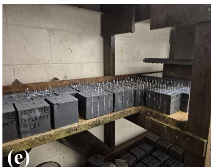
Figure 3.3 : Procédure de fabrication des prismes de BFUP
