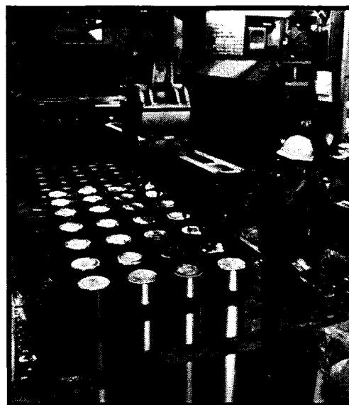
Figure 2.3 : Puits de coulée des billettes (Alcan Inc., 2003)
