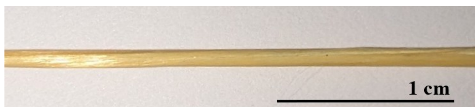
Figure 3.8 : Fil Kevlar/TPU torsadé pultrudé avec \alpha_{post} = 5^\circ
