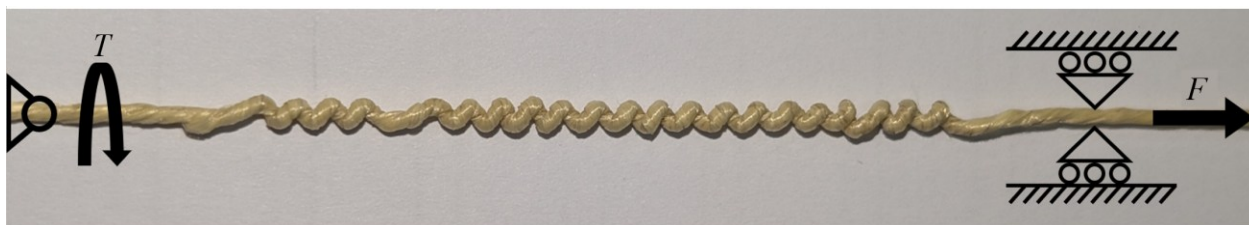
Figure 4.1 : Schéma de mise en forme d'un muscle artificiel par « Twist insertion »
