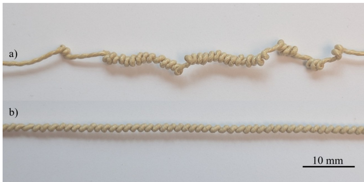
Figure 4.5 : Muscles artificiels au repos, a) sans stabilisation, b) avec stabilisation
