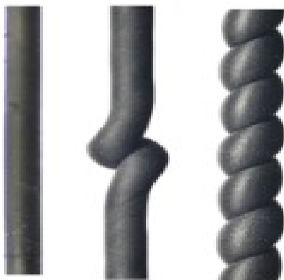
Figure 2.5 : Étape de la formation des spires par la méthode IST [39] Droits obtenus
