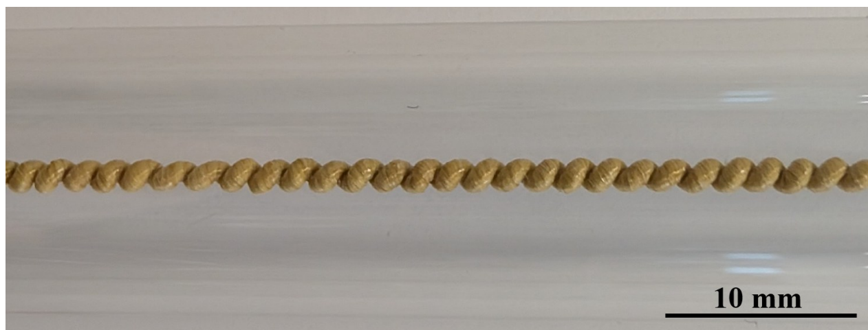
Figure 4.10 : Muscle artificiel spiralé 15° Kevlar/TPU sous tension dans le tube de chauffage à température pièce
