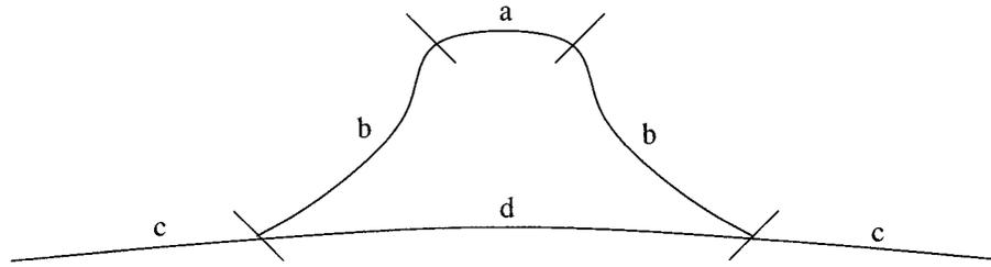
figure 3.10 Coupe transversale de la représentation topographique d'une réflexion spéculaire. **a** représente le pic spéculaire, **b** le lobe spéculaire, **c** la zone de réflexion diffuse et **d** la surface sans réflexion spéculaire
