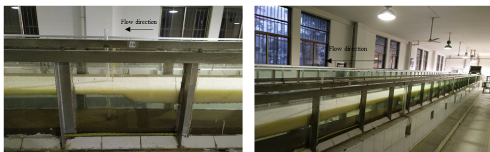
FIGURE 2.17 Dispositif expérimental pour l'étude de migration d'une onde de particules de glace [20]
