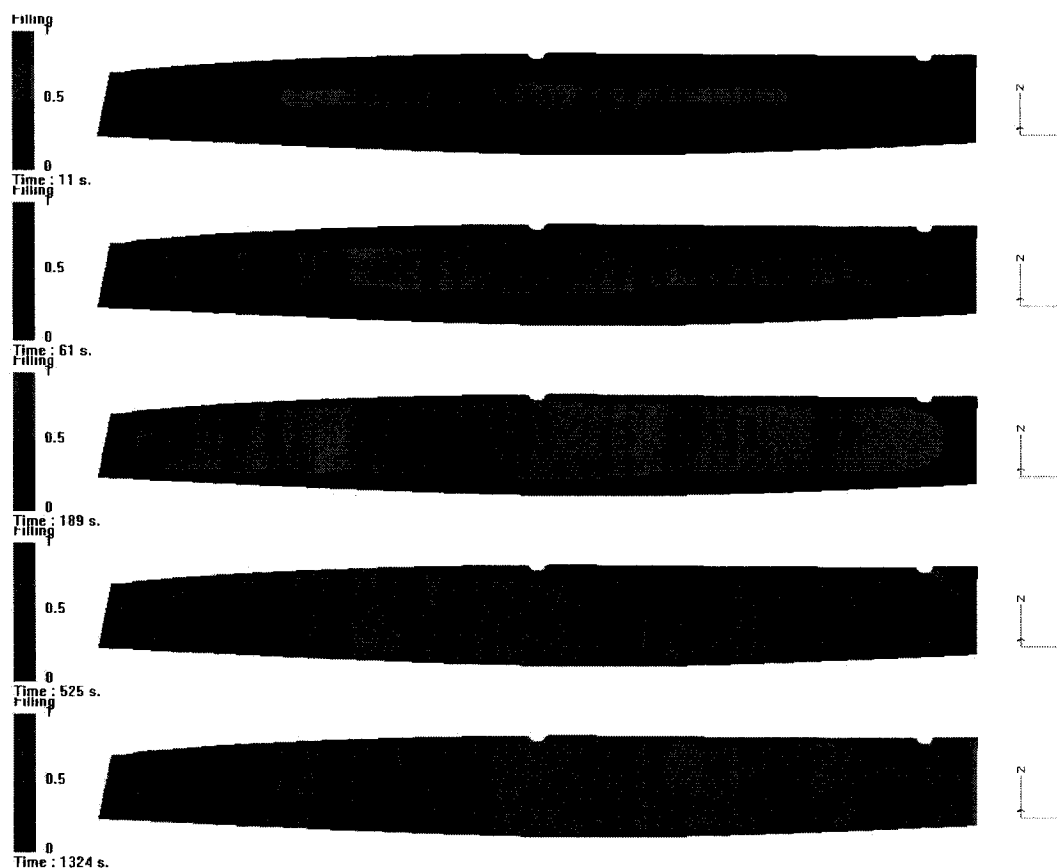
Figure 5.9 : Remplissage de la coque avec la quatrième stratégie d'infusion.
