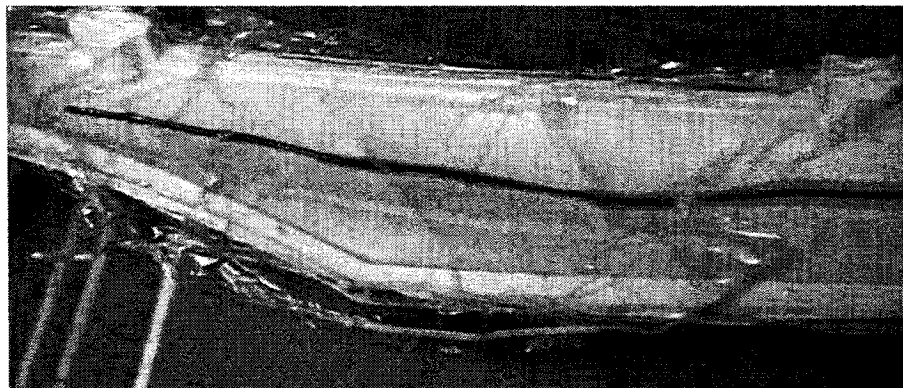
Figure 6.11 : Remplissage de la torsade à t = 25 s.
