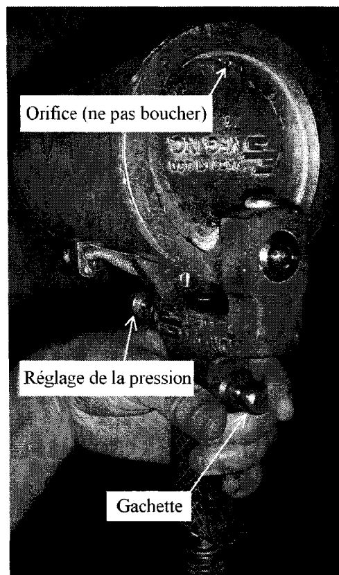
Figure 0.8 : Orifice, bouton de réglage de la pression et gachette du pistolet.
