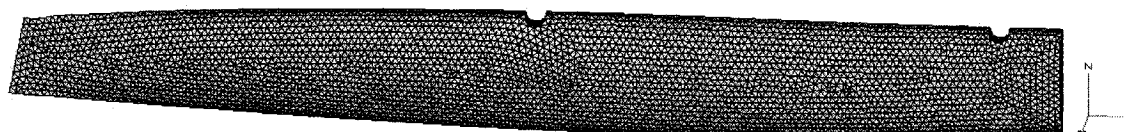
Figure 5.1 : Maillage de la coque pour les simulations préliminaires.
