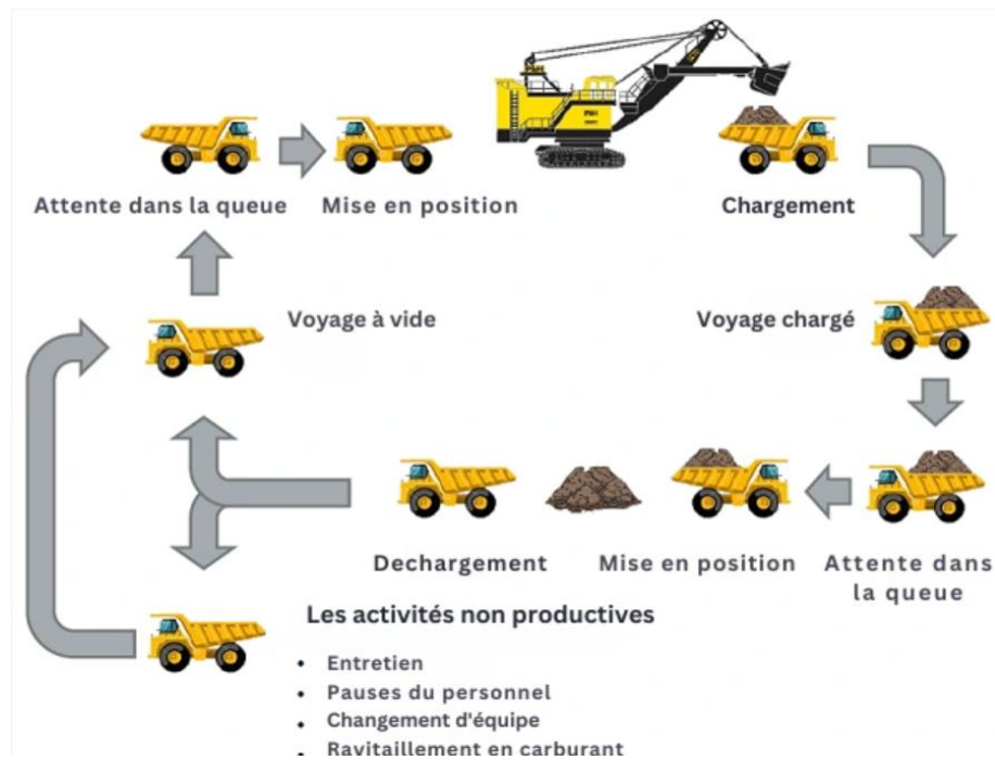
Figure 4.1: Cycle opérationnel du système camion–pelle dans une mine à ciel ouvert (AnyLogic, s. d.).
