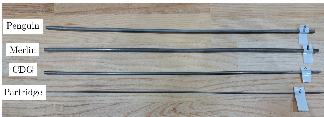
FIGURE 4.14 Échantillons de brins centraux de câble de garde et de coeur de câble ACSR.
