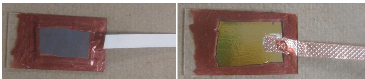
Figure 2.3: Vue de face (gauche) et de dos (droite) de la membrane d'alumine prête pour l'électrodéposition. La surface d'électrodéposition (bleu) mesure ici environ 4 \times 2 \text{ cm}^2 .
