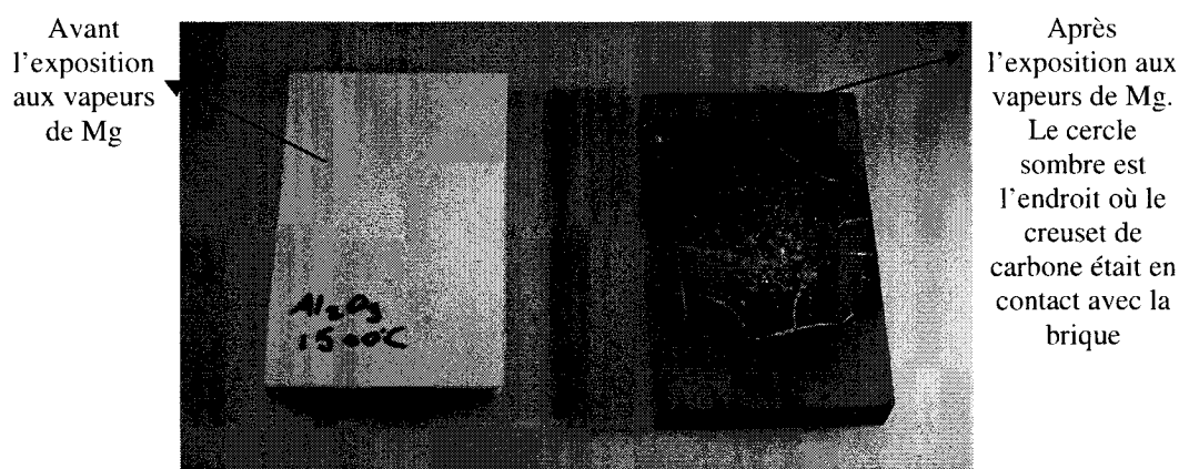
Figure 5-16 : Apparence de la brique d'alumine après une exposition de 24 heures aux vapeurs de Mg à 850°C
