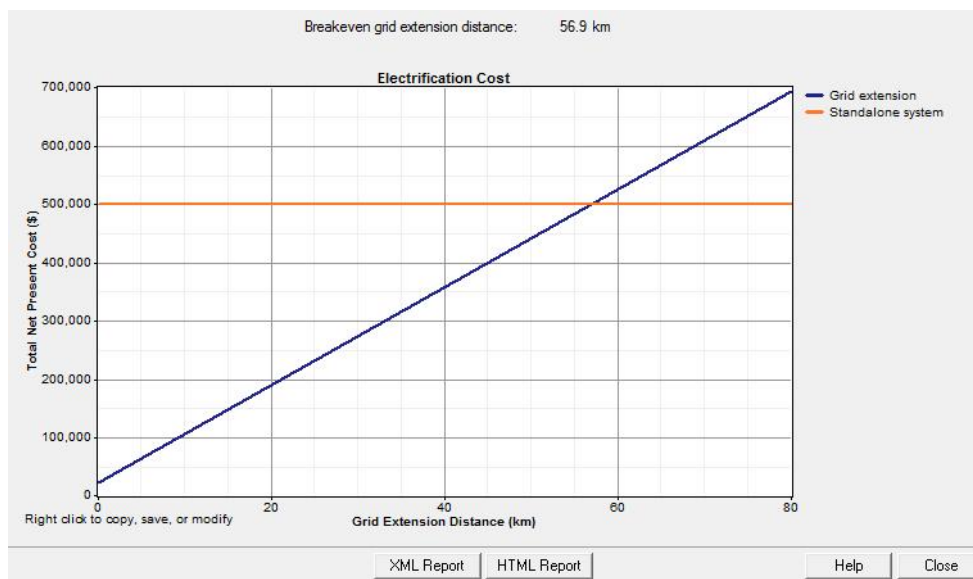
Figure 6.13 Analyse de la distance du réseau pour le seuil de rentabilité du système photovoltaïque en comparaison avec le système connecté au réseau
