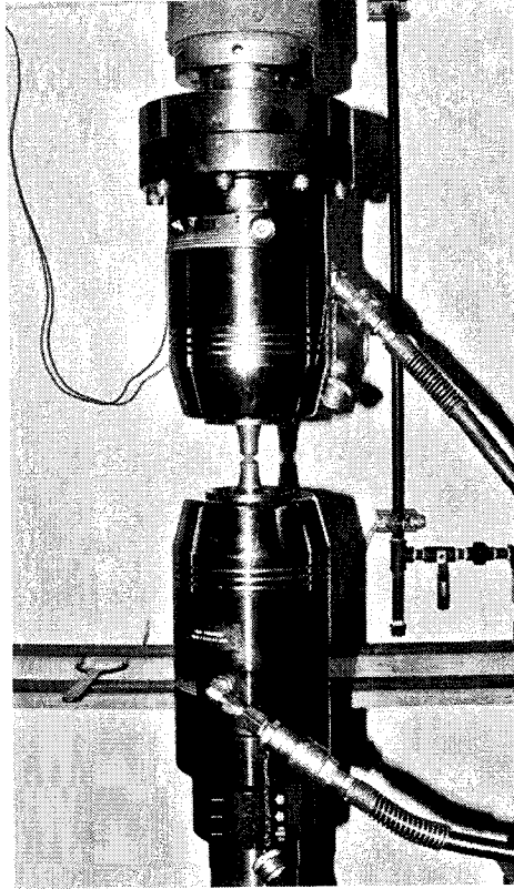
Figure 6. 4. Montage avec mors hydrauliques
