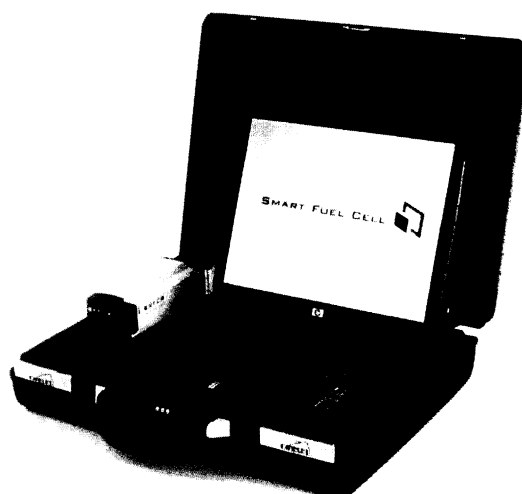
FIG. 1.18 Ordinateur portable fonctionnant avec une pile au méthanol fait par la compagnie Smart Fuel Cell 75
