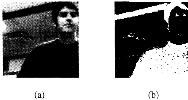
Figure B.1 – Seuillage : a) image originale, b) image binarisée.
