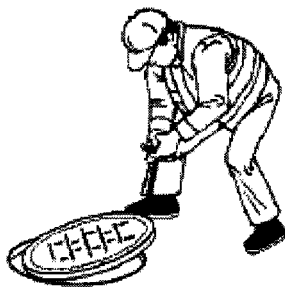
Figure 1.1 : Ouverture d'un couvercle à l'aide d'un crochet
