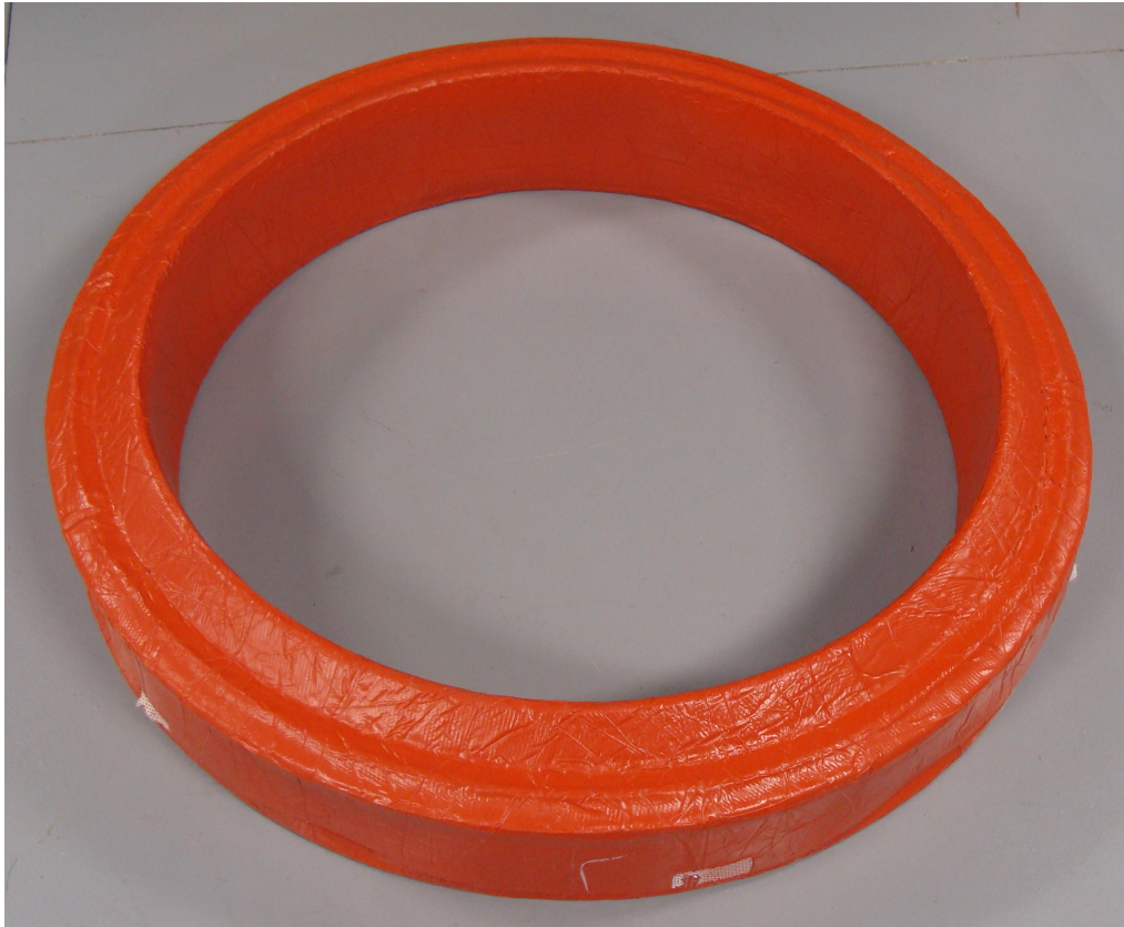
Figure 3-3 Membrane fabriquée avec le moule mâle.
