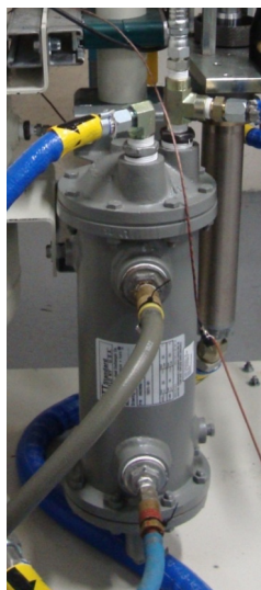
Figure 4-5 : Échangeur de chaleur installé sur la nouvelle machine de compaction.
