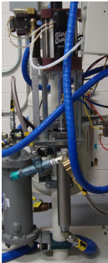
Figure 4-3 Assemblage de la pompe sur la nouvelle machine de compaction.
