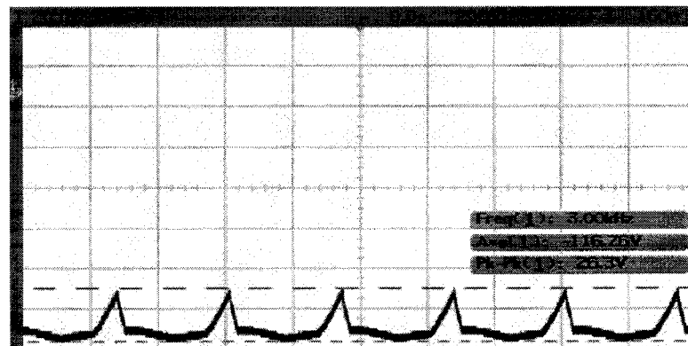
Figure 3.16 Commutation de 12 électrodes sans transfert de charges en haute fréquence
