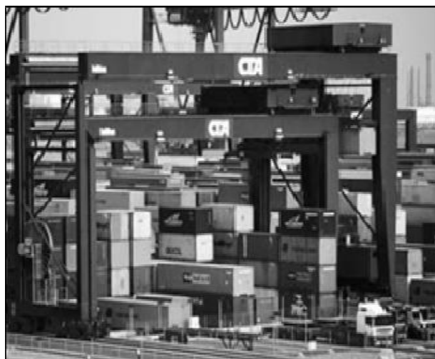
1- Portique de cour
