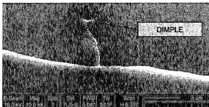
Figure 5.18 : Gros plan au MEB sur une fissure entre la fracture et un DIMPLE (IMUPMRPM)
