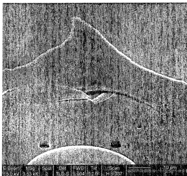
Figure 5.16 : Vue 1 - Mise en évidence au MEB d'une fissure dans la zone de pivot (IMUPMRPM)
