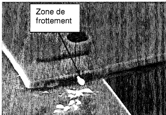
Figure 5.40 : Image au MEB de la zone de blocage d'une pale de rotor à contrôle par le dessous
