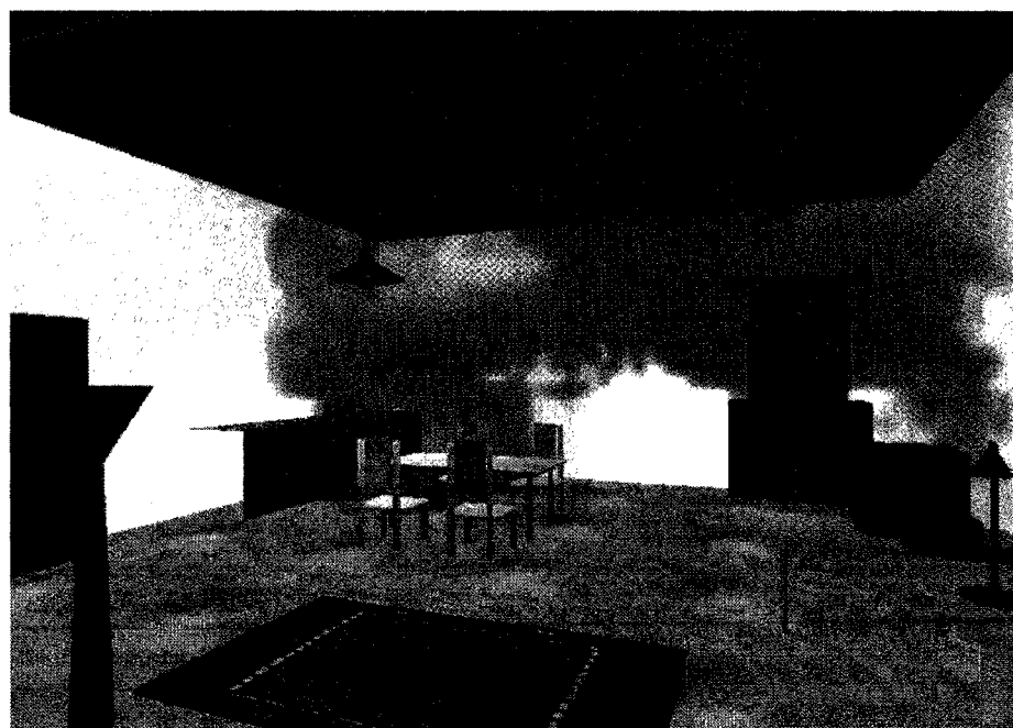
Figure 4.3 État de la fumée après 250 secondes
