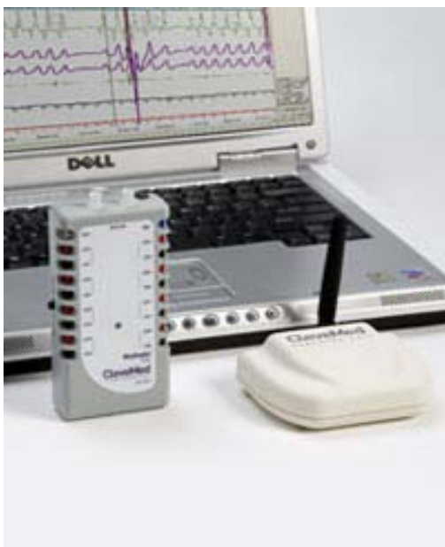
Figure 2-10. Système d'acquisition de données sans fil BioRadio (CleveMed).
