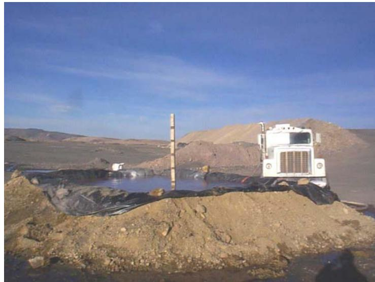
Figure 3.9 Bassin TP-1 rempli (avec la fluorocine dans l'eau).
