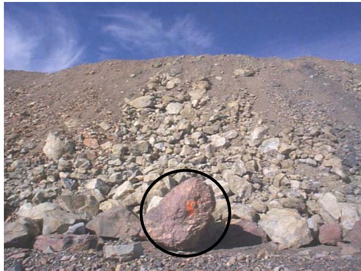
Figure 3.4 Ségrégation qui se retrouve le long d'une pente à la mine Goldstrike (le bloc encerclé a une hauteur d'environ 1,8 m).
