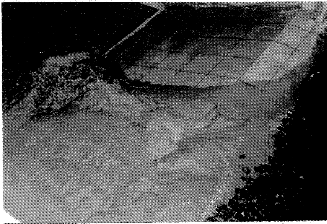
Figure 4.9 : L'augmentation de la déverse initie une brèche secondaire en rive gauche (T= 124 secondes).
