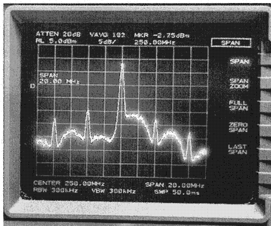
Figure 7.11. La photo du spectre récupéré correspondant à une vitesse de modulation de 2 \times 4 Mb/s
