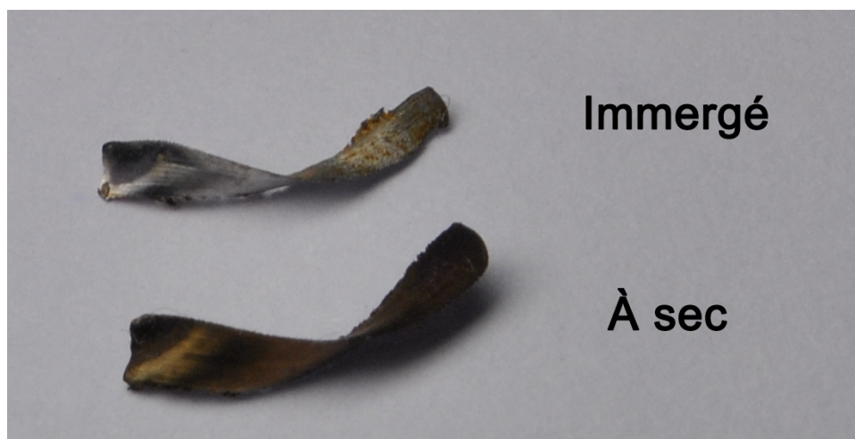
Figure 7.4 Comparaison des copeaux en fonction du milieu de coupe
