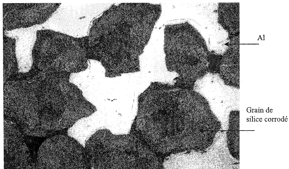
Figure 6-7 : Photographie de la poudre de silice corrodée à l'interface métal - poudre
