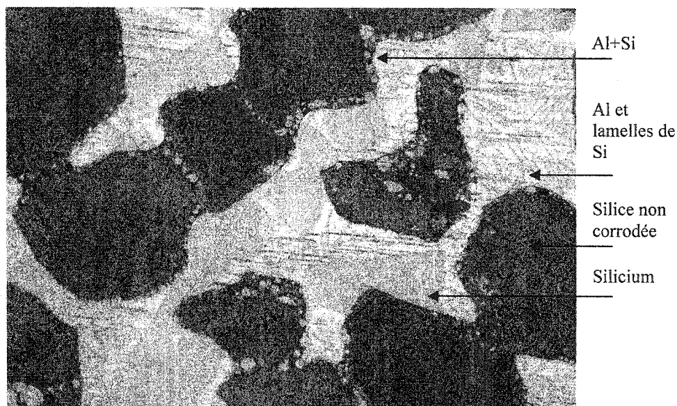
Figure 6-8 : Photographie de la poudre de silice pénétrée au front de pénétration
