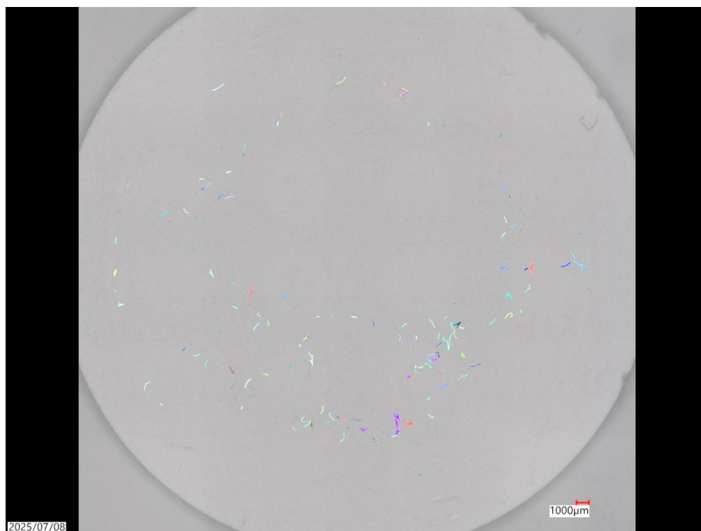
Figure 4-2 : fibres en polyester après isolation au microscope Keyence. Taille : 50-300 \mu\text{m} . Volume filtré : 20 mL
