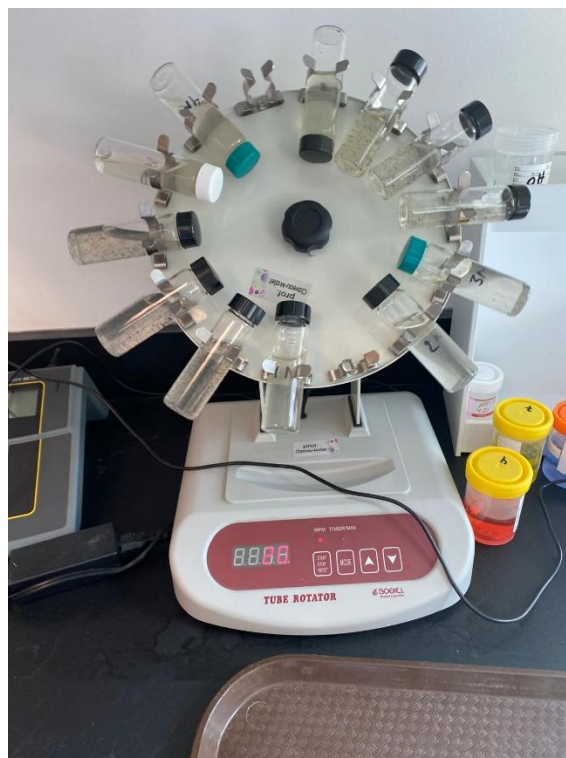
Figure 3-1 : Étapes de conditionnement des MP avec un rotateur
