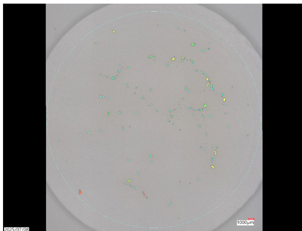
Figure 4-4 : fragments en caoutchouc isolé au microscope Keyence. Taille : 180 – 300 \mu\text{m} . Volume filtré : 20 mL
