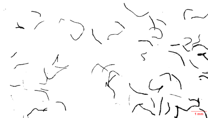
Figure 4-6 : image des fibres isolées avant traitement avec imageJ
