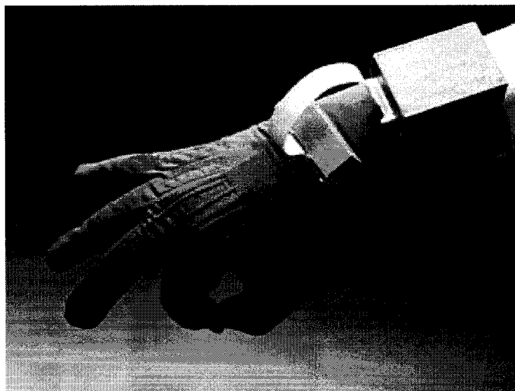
Figure 2.6 - Gant virtuel à 2 senseurs par doigt, mesurant aussi l'abduction entre les doigts (5DT)
