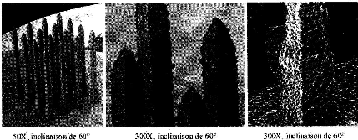
Figure 2.11 Matrice carrée de 16 microélectrodes faites de titane
