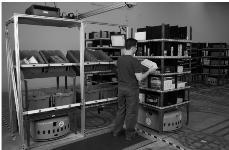
FIGURE 1.2 Photographie d’une station de travail présentant un travailleur complétant des commandes à l’aide de les stocks apportés par un robot, tirée de l’article de Wurman et al. [20]
