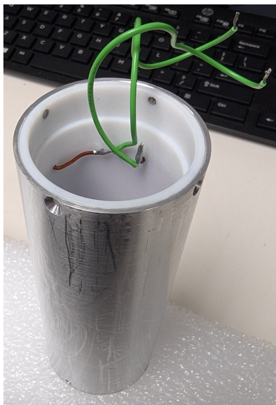
FIGURE 3.10 Image du cylindre dans lequel la bobine de modulation a été intégrée où la coquille en aluminium, le support central en téflon et les fils d'alimentation de la bobine sont montrés.
