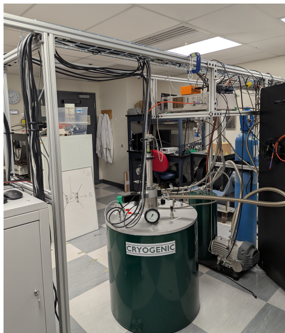
FIGURE 3.14 La structure de métal autour du montage permettant de ranger les câbles en hauteur et la tablette permettant d'installer les instruments près du haut de l'insertion.
