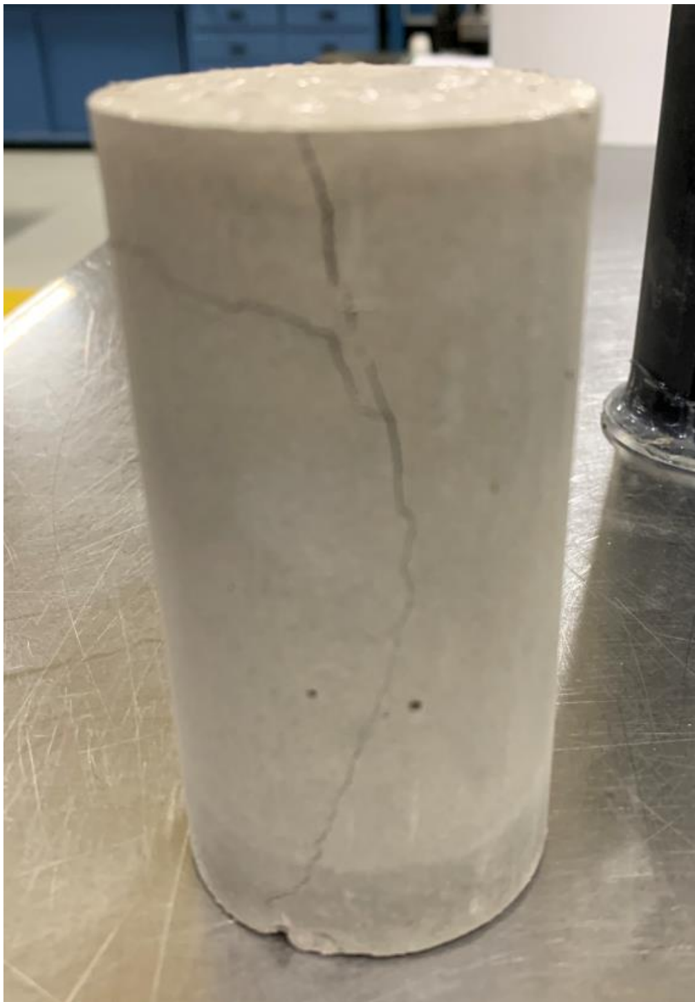
Figure A.6 : Exemple de fissure de type 1 et 3 observée lors des essais de compression uniaxiale
