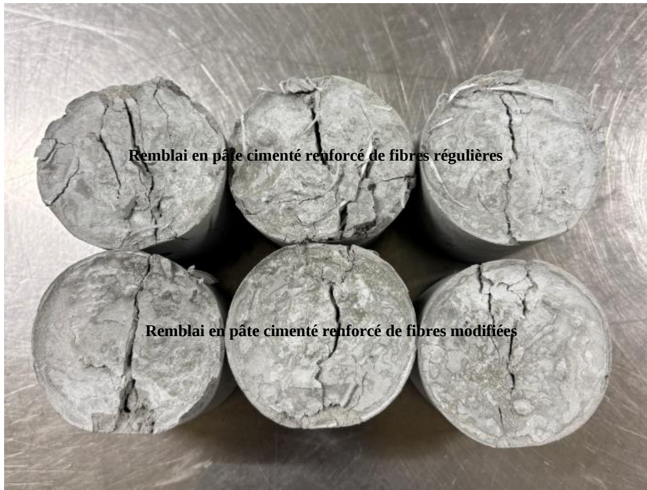
Figure B.7 : Exemple de présentation des échantillons de remblai en pâte renforcé avec 1% de fibres régulières et renforcé avec 1% de fibres modifiées après les essais de traction indirecte à un temps de cure de 14 jours
