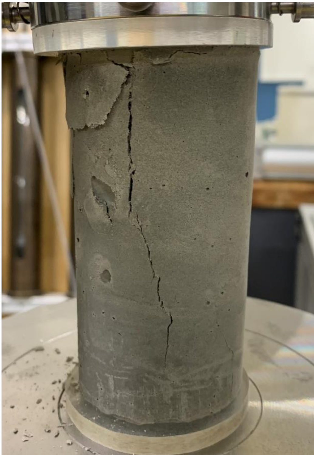
Figure A.5 : Exemple de fissure de type 3 observée lors des essais de compression uniaxiale
