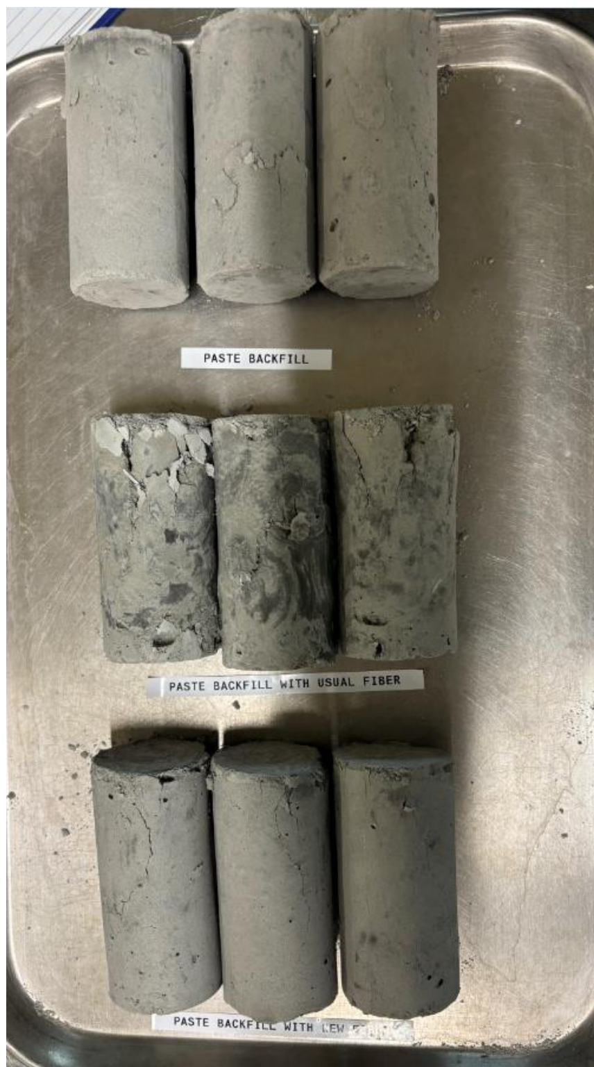
Figure A.9 : Exemple de présentation des échantillons de remblai en pâte non-renforcé, renforcé avec des fibres régulières et renforcé avec des fibres modifiées après les essais de compression uniaxiale à un temps de cure de 7 jours
