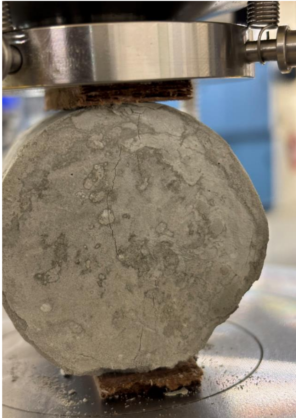
Figure B.1 : Exemple de fissure observée lors des essais de traction indirecte
