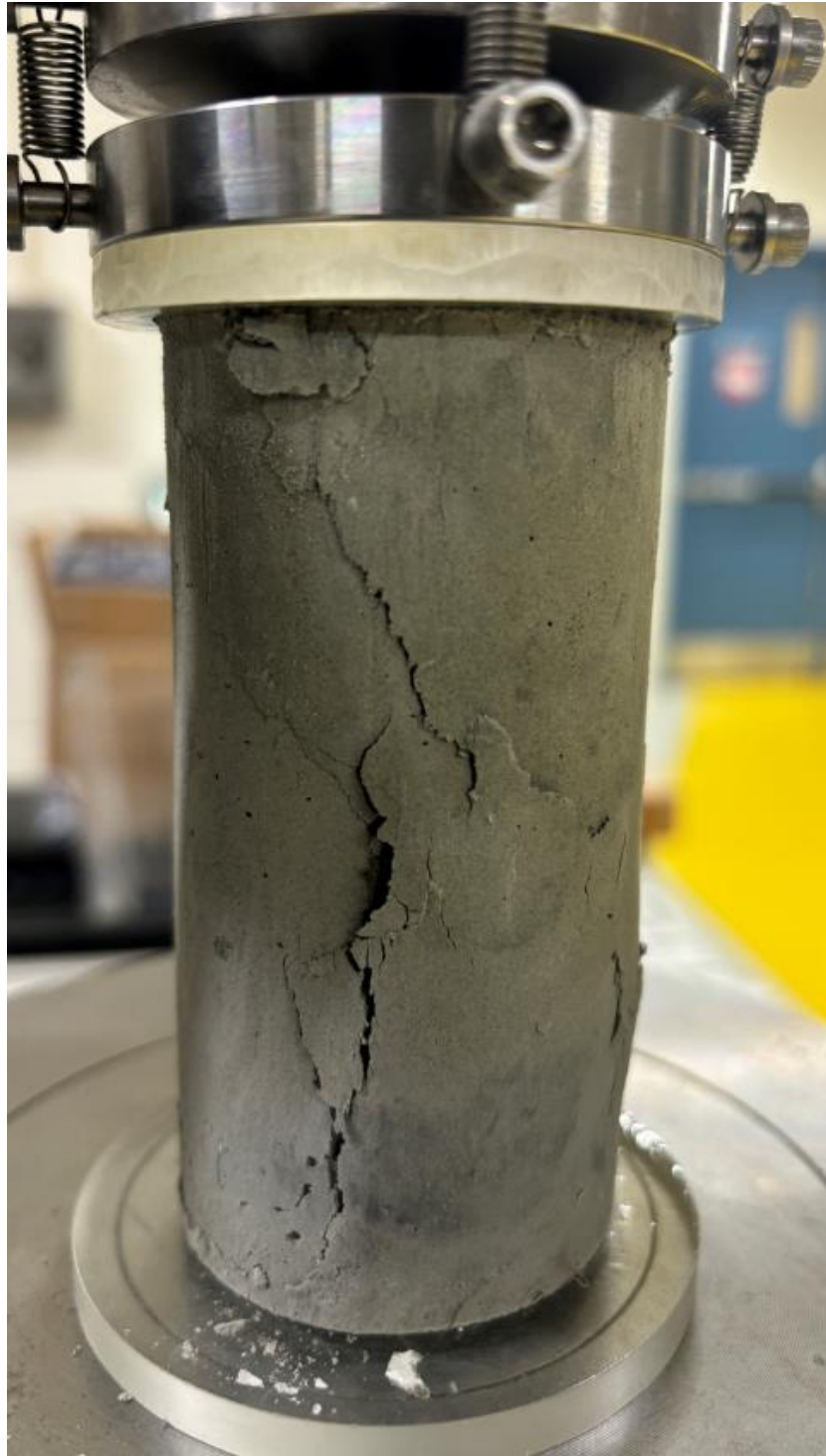
Figure A.7 : Exemple de fissure de type 3 observée lors des essais de compression uniaxiale
