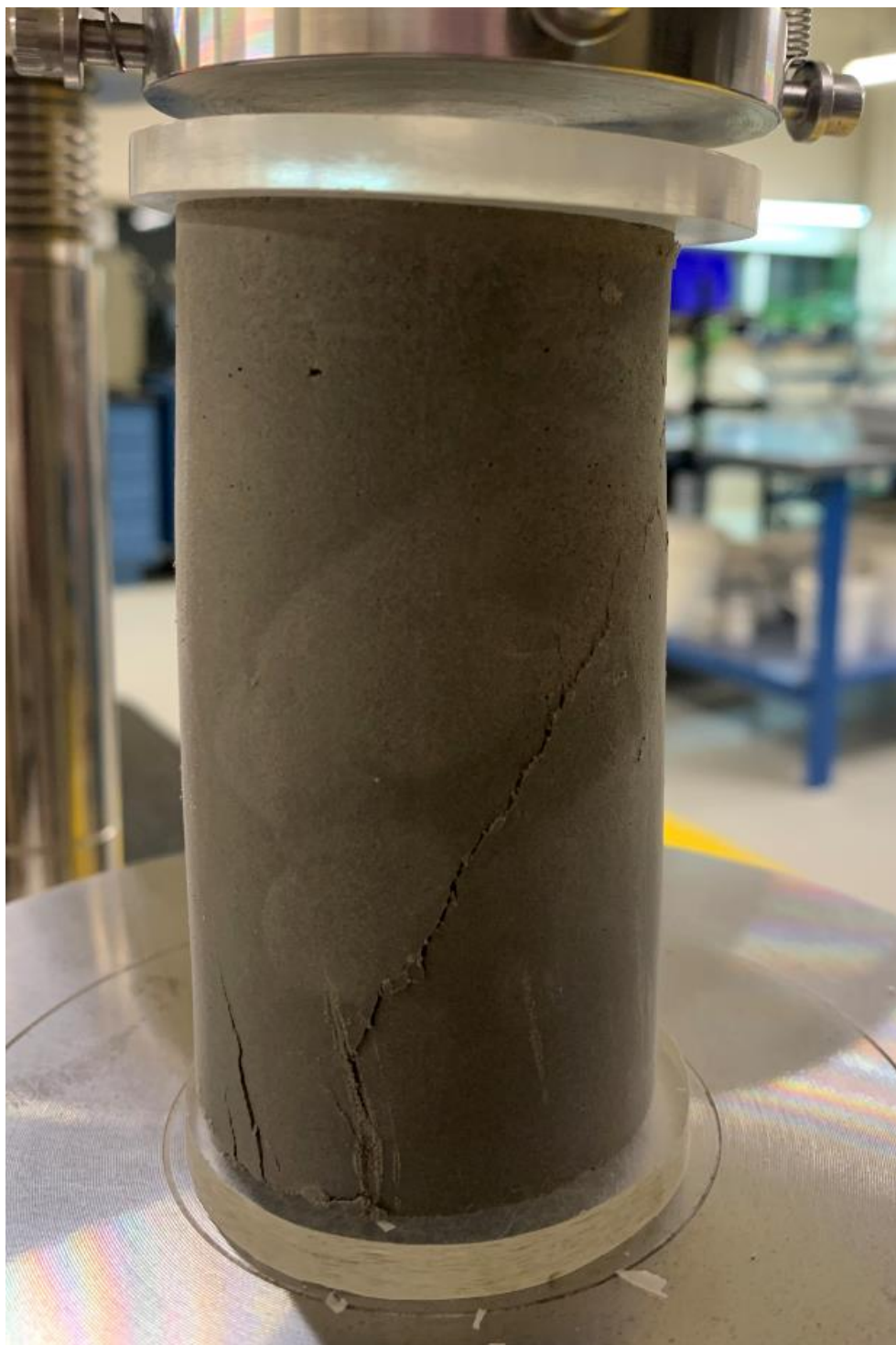
Figure A.3 : Exemple de fissure de type 1 observée lors des essais de compression uniaxiale
