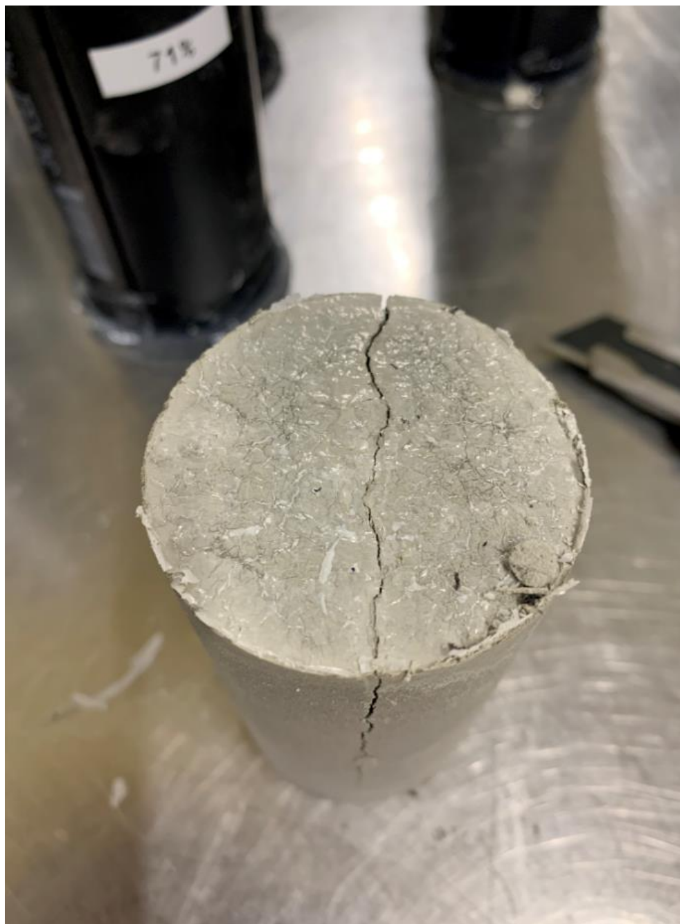
Figure A.1 : Exemple de fissure de type 3 observée lors des essais de compression uniaxiale
