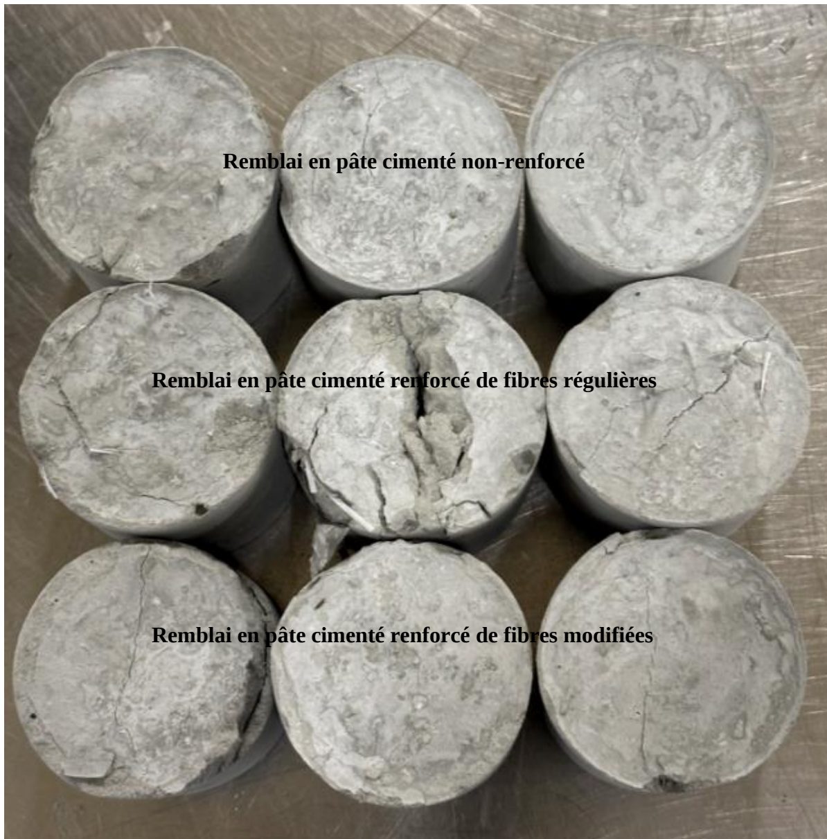
Figure B.6 : Exemple de présentation des échantillons de remblai en pâte non-renforcé, renforcé avec 0,5% de fibres régulières et renforcé avec 0,5% de fibres modifiées après les essais de traction indirecte à un temps de cure de 14 jours
