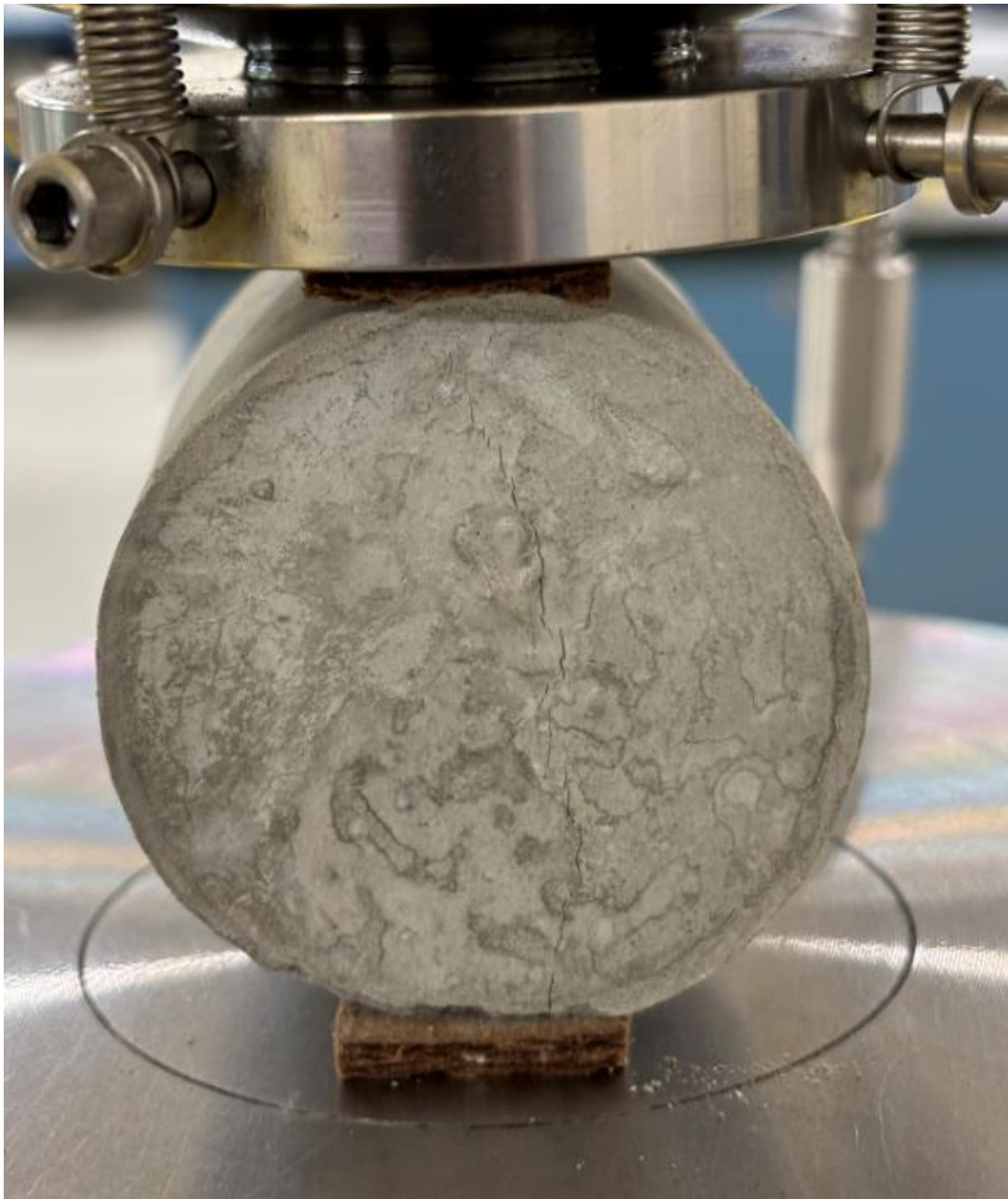
Figure B.4 : Exemple de fissure observée lors des essais de traction indirecte
