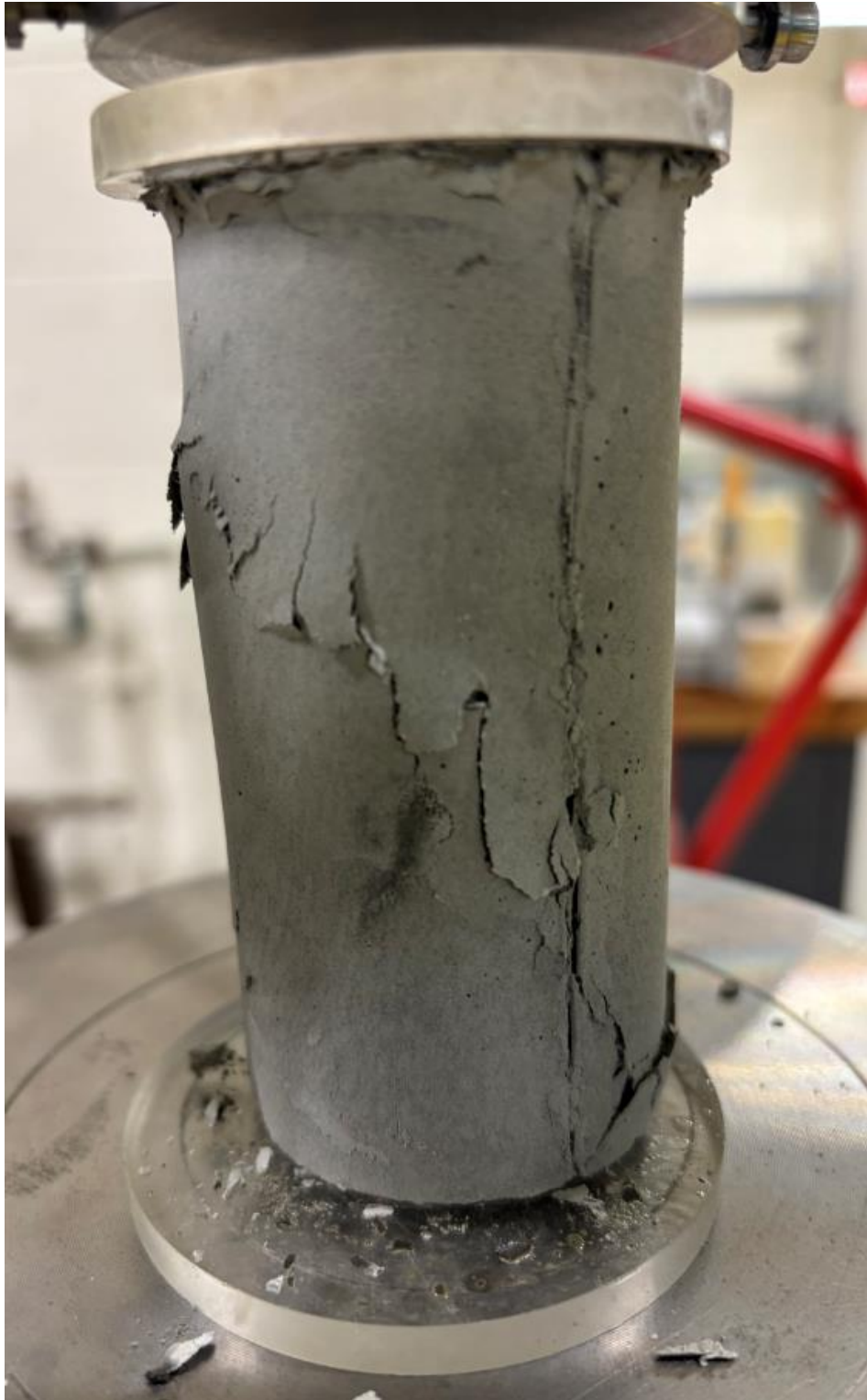
Figure A.10 : Exemple de fissure de type 1 observée lors des essais de compression uniaxiale
